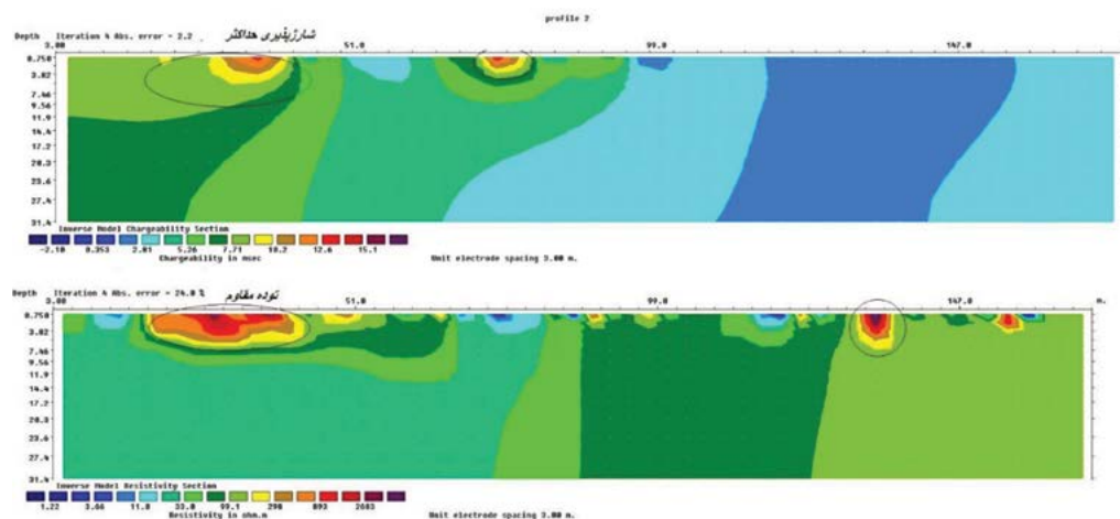
شکل ۴ - پروفیل دوم مقاومت ویژه واقعی با واحد اهم متر (پایین) و شارژپذیری با واحد میلی ثانیه (بالا) که بخش های با شارژپذیری بالا (زون کانه دار) و مقاومت بالا در بخش های چپ پروفیل را نشان می دهد.
